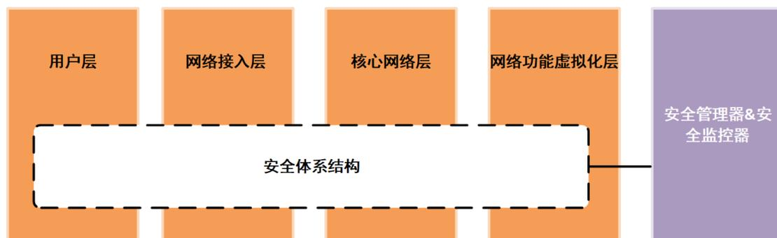
5G 安全构架负责保护端对端的通信，提供身份验证、安全审计、安全管理等其他安全相关的功能。5G 安全构架由多种网络功能（NF）构成，所以安全体系结构需要横跨很多的其他组件结构。安全构架需要保障 5G 构架的方方面面，如无线电接入网络（RAN）、边缘计算功能（MEC）、网络功能虚拟化（NFV）等。
