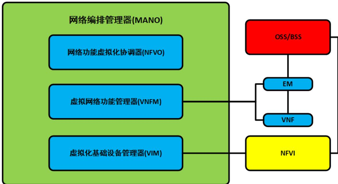
网络编排管理器是 5G 的重要组成部分之一，他负责 5G 所有重要组件的功能配置与管理，包括网络功能虚拟化（NFV）、虚拟化网络功能（VNF）、虚拟化基础设施（VIM）。通过 MANO 可以控制整个 5G 网络的基础设备，所以应该对其进行严格的权限分配，以应对未知风险。
