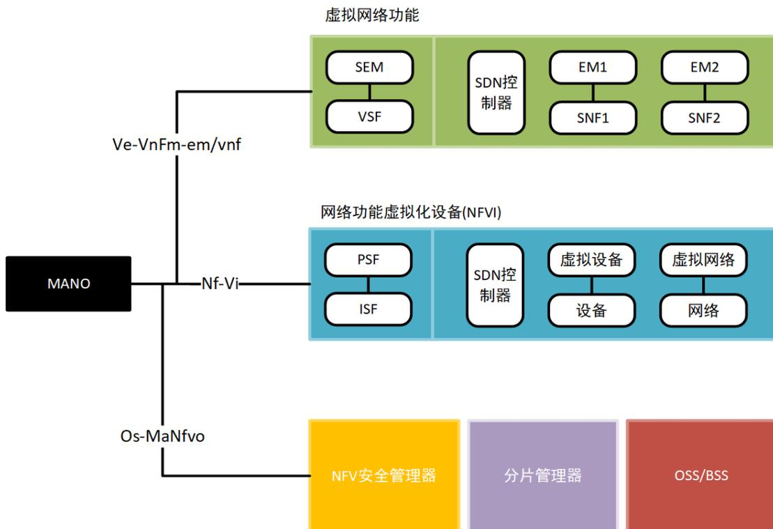
NFV 是 5G 网络最重要的基础服务之一，5G 使用标准 IT 虚拟化技术对网络功能进行虚拟化部署，降低部署门槛，提高通用性，以便更加便捷的提供新的网络服务。5G 网络环境中，网络功能虚拟化(NFV)包含了虚拟网络功能（VNF）、OSS/BSS、以及安全管理软件，他们能够通过 MANO 统一调度与其他功能产生交互，从而使各个模块紧密快速的联系在一起。NFV 具备的功能列表如下：
