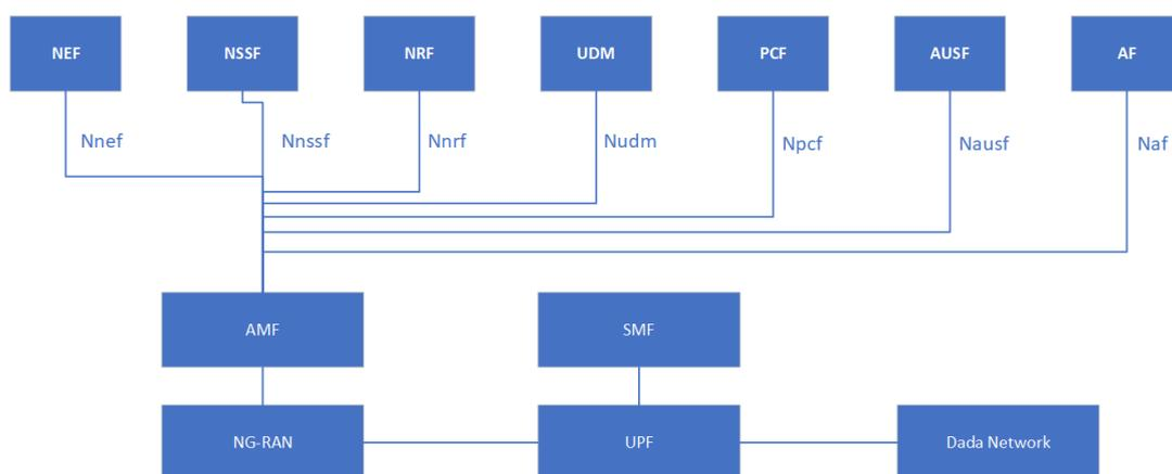
5G 核心网络，是为了支持更高吞吐量而建立的，是 5G 构架的核心关键系统。3GPP 规定，5G 核心必须采用 SBA 架构来支持云服务。5G 核心的主要功能是负责
