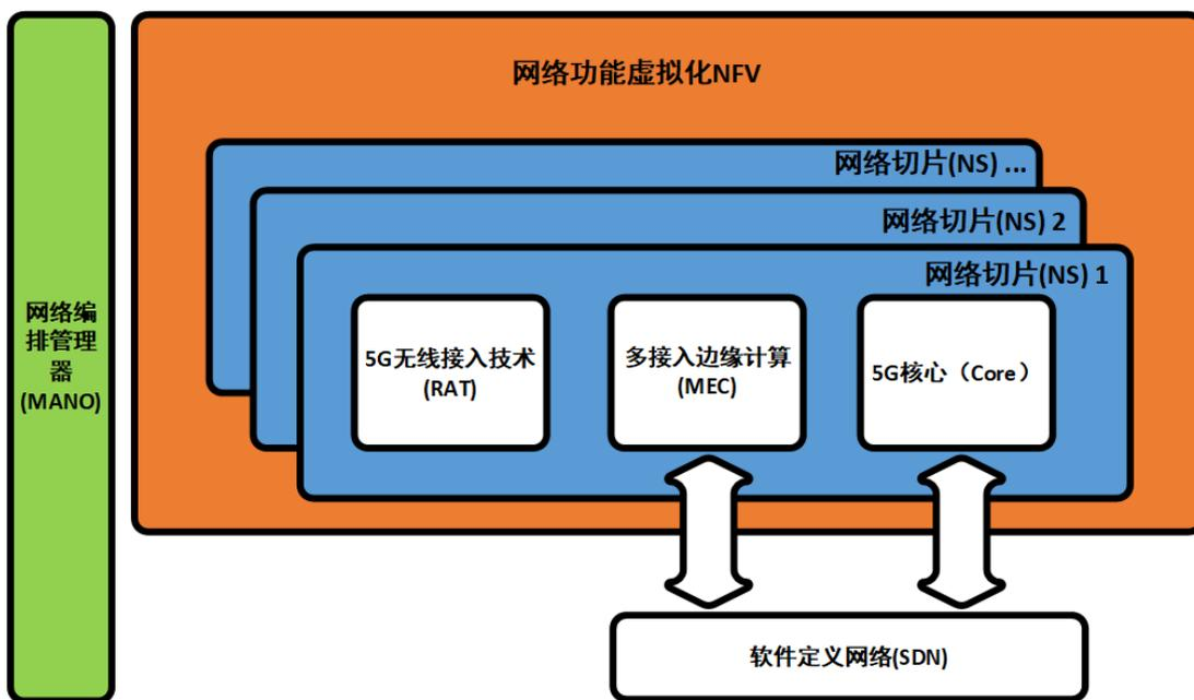
重要的组件包括核心网络（5G Core）、网络功能虚拟化（NFV）、网络切片（NS）、软件定义网络（SDN）、多访问边缘计算（MEC）、无线电接入网络（RAN）、网络编排管理器（MANO）、安全体系结构（SA）。从上图可看出，整个 5G 构架，以网络功能虚拟化技术为基础，使用虚拟化技术模拟与集成 5G 中所使用的组件，并使用 SDN，在 MEC 与核心网络之间进行数据分类传输。
