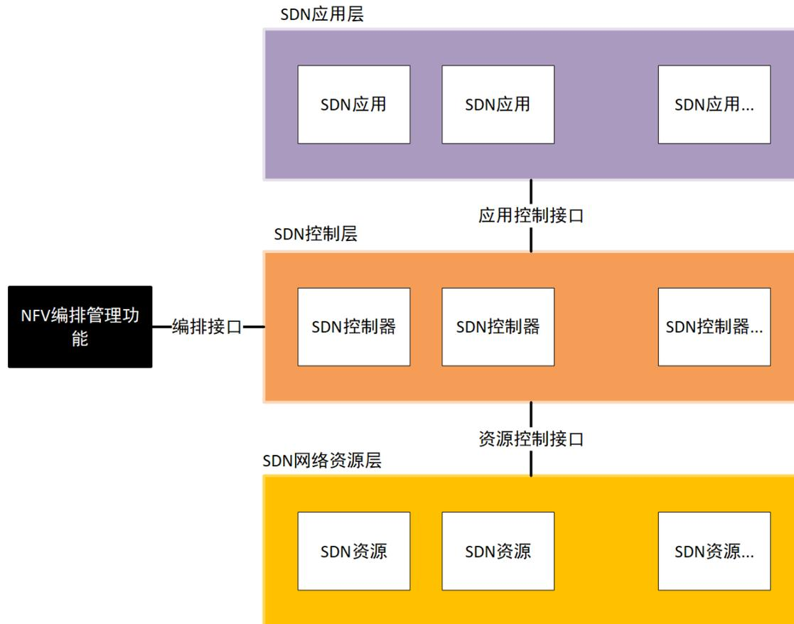
SDN 是 5G 所有的特色服务。SDN 通过解耦网络，来控制、分组、转发网络功能，从而实现对网络功能的集中控制。为了更好的优化网络服务，在 SDN 中，转发和控制是分开的。SDN 依赖于网络中控制和分组转发功能的解耦，在经典网络中，这两个功能由专用物理设备负责，在 SDN 中，这两个功能被隔离为两个功能平面：控制平面和数据平面。网络的功能分离，一方面降低了配置与更改的难度，另一方面，提供了同一的控制器，增加了普适性。
