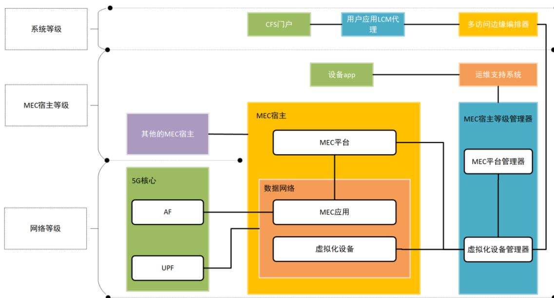
如无人驾驶、远程手术等应用情景，需要极高的带宽、极低的延时。为了确保这些应用可以正确运行，则需要 MEC 服务进行支持。MEC 提供了在网络边缘进行云计算的能力。MEC 通常是已授权的第三方服务，其通常位于基站的逻辑附近，可为 5G 用户提供应对不同场景的处理和存储能力。MEC 是 5G 生态系统中的创新之处，它会覆盖前几代通信设备，来增强用户体验。MEC 可将不同的应用流量，按照类别进行分类处理，如视频、定位位置、虚拟现实等。这样可根据不同的优先级，对有限的资源进行不同的安排。
