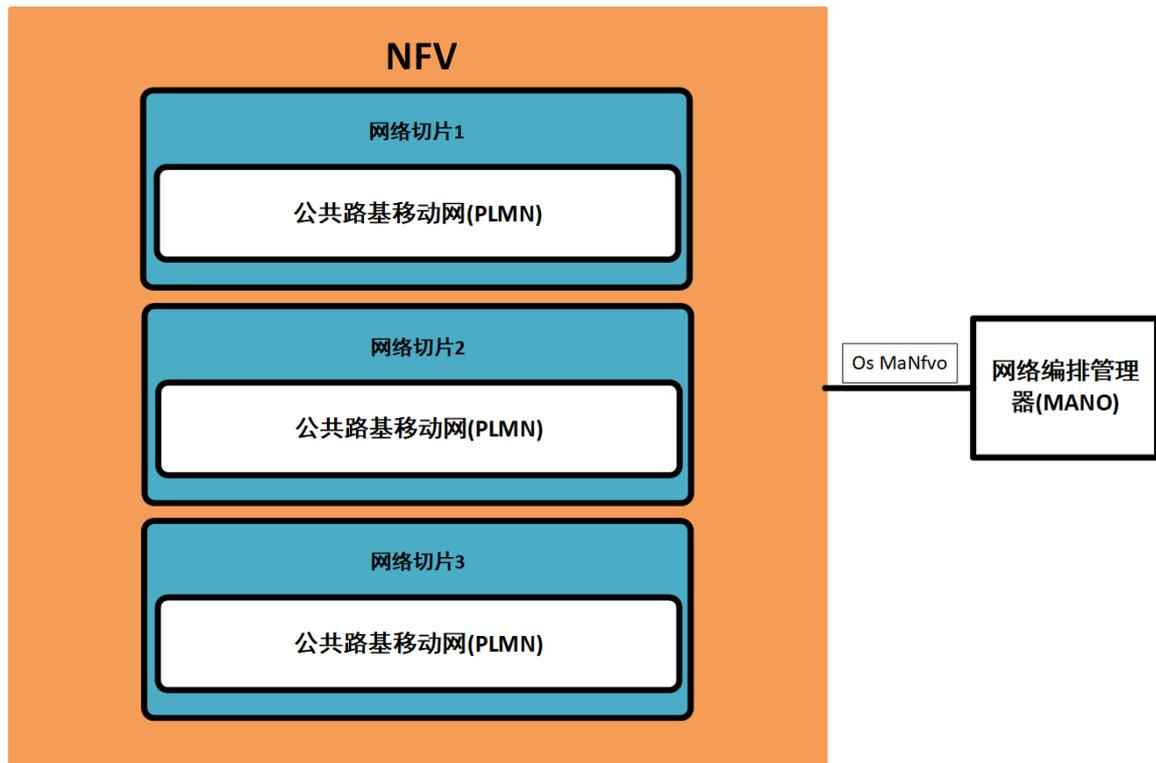
网络切片是以 NFV 为基础而实现的，在 5G 系统架构中是基础支持部分。在 3GPP 定义的 5G 系统构架中，网络切片是通过对指定功能进行模拟集成，共同形成向 UE 设备提供完整 PLMN（公共陆基移动网）功能的系统。5G 环境的切片系统十分强大，包含涵盖了整个 PLMN。网络切片允许建立特定功能的 PLMN 系统，这些定制的 PLMN 将为不同环境下的不同需求提供服务。网络切片是灵活的，其可以根据具体的应用场景，通过 MANO 调整其内部的服务功能。
